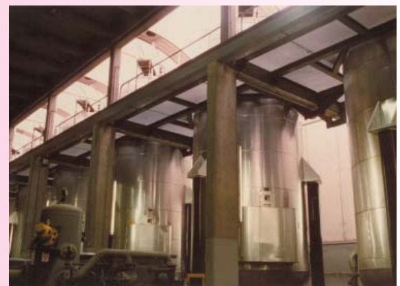
b. Atelier de cuisson : réacteurs de cuisson et échangeur de chaleur (Seine aval) © Dominique Soulié
